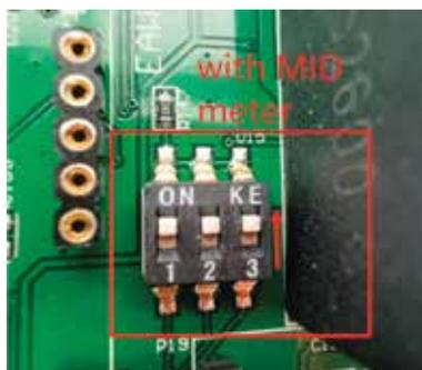
Na foto ao lado está a configuração quando tem o carregador com um contador MID extra. Com o contador, o interruptor 3 está na posição PARA CIMA. No carregador sem contador MID, a chave 3 deve estar sempre na posição DOWN.
