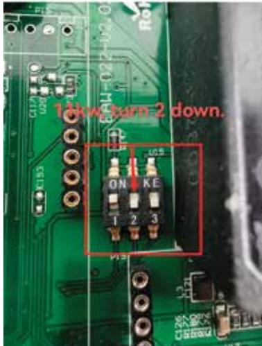
Para alterar a potência de saída de 22kW para 11kW, pressione o segundo interruptor para baixo.
