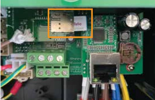
Para estabelecer a conexão 4G, adicione um cartão SIM no slot do cartão SIM dentro do carregador. Remova a tampa frontal para alcance o slot do cartão SIM dentro do carregador. Antes de instalar o cartão SIM, remova o PIN do cartão. Certifique-se de que o carregador está desconectado da fonte de alimentação antes de instalar o cartão SIM!
