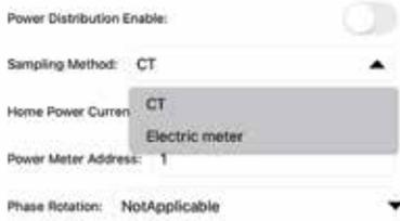
Se um TC externo for instalado para amostrar a corrente da rede doméstica, a função DLM pode ser usada para controlar a corrente de saída. Para ativar a função DLM, ligue: Ativação de distribuição de energia. O valor do item Sampling Method precisa ser CT e Home Power Current é definido para um valor menor que a distribuição máxima da corrente em sua casa.
